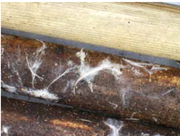
Bild 20: Halm mit Oberflächenmyzel
