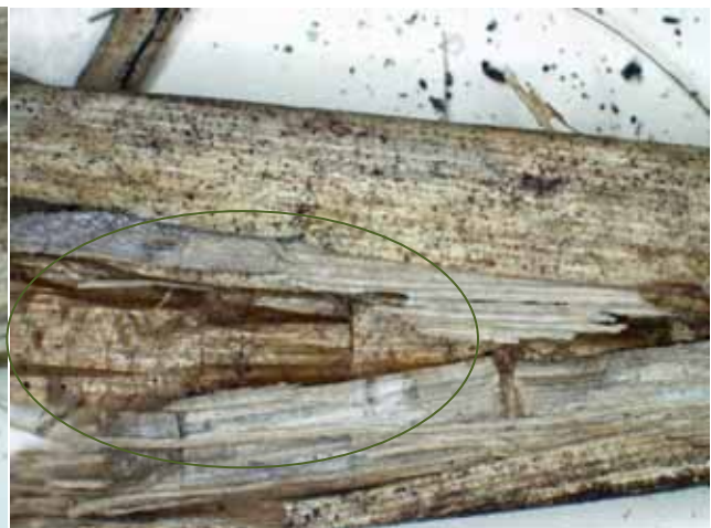
Bild15: braunfäuleähnlicher“ Bruch der Halme
