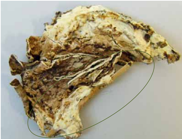
Bild 13: Fruchtkörper Brauner Kellerschwamm ( Coniophora puteana ) auf Reet
